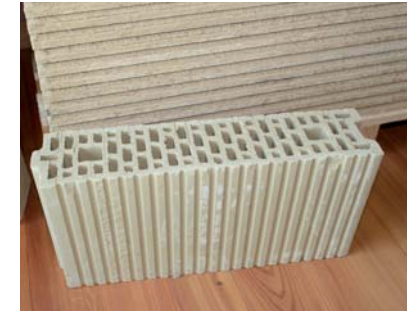
→ Roland Meingast erfindet weiter. Derzeit in der Entwicklung und Erprobung: ein statisch tragender, ungebrannter Lehmziegel. Für seine Herstellung wird praktisch keine Energie mehr verbraucht.
