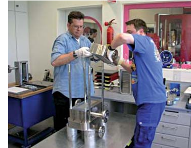
→ Aufbau des Produktionsmikroreaktors am Institut für Mikroverfahrenstechnik des Forschungszentrums Karlsruhe.
