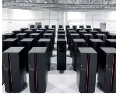
→ Paralleles Rechnen: Jülichs neuer Supercomputer, aus 41 Einzelrechnern mit insgesamt 1312 Prozessoren.
